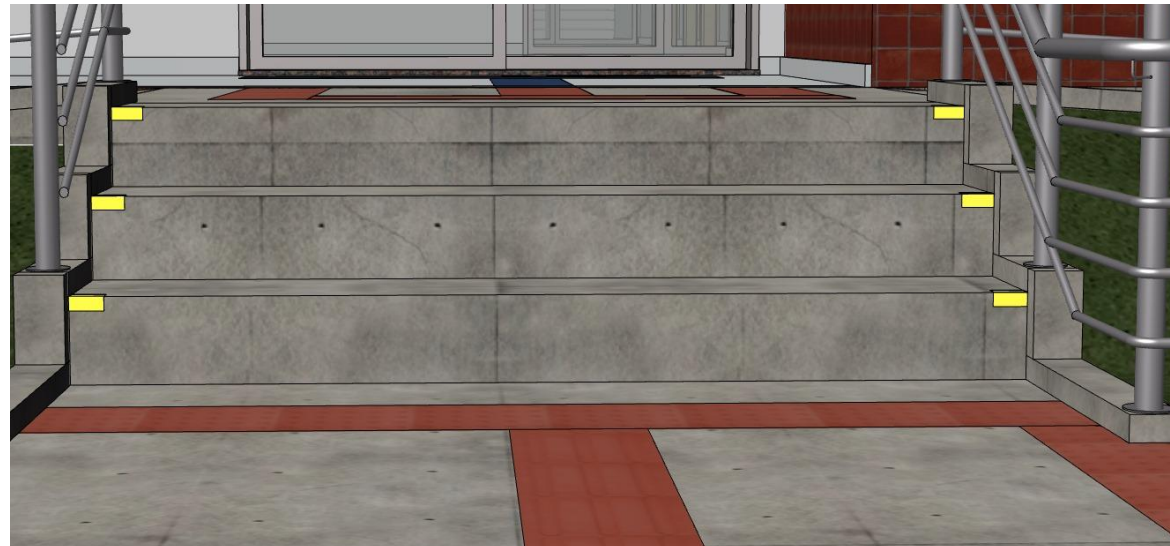
Perspectiva - Sinalização de escadas NBR 9050:2015
