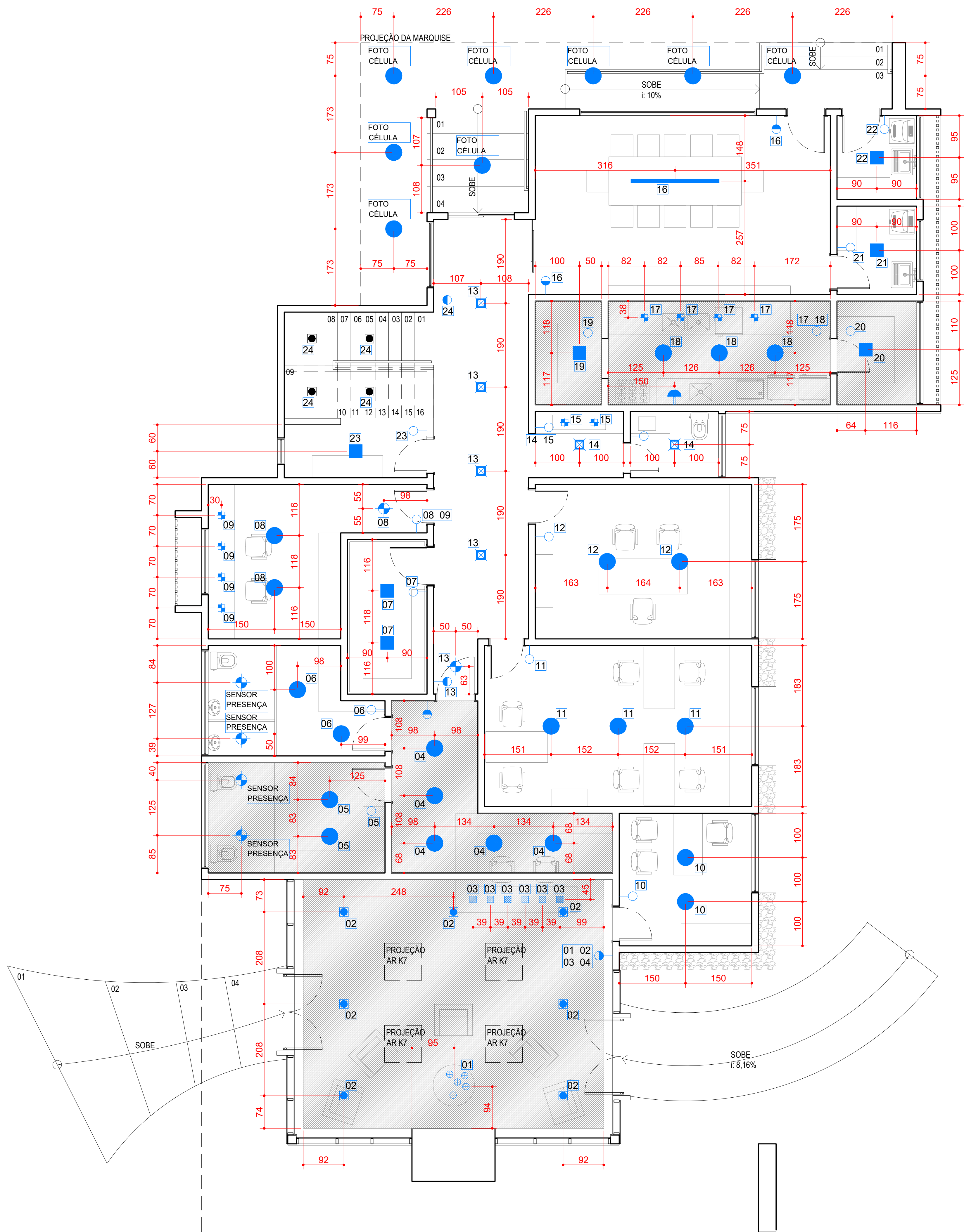
PLANTA BAIXA DE ILUMINAÇÃO PAVIMENTO TÉRREO ESC 1:50
