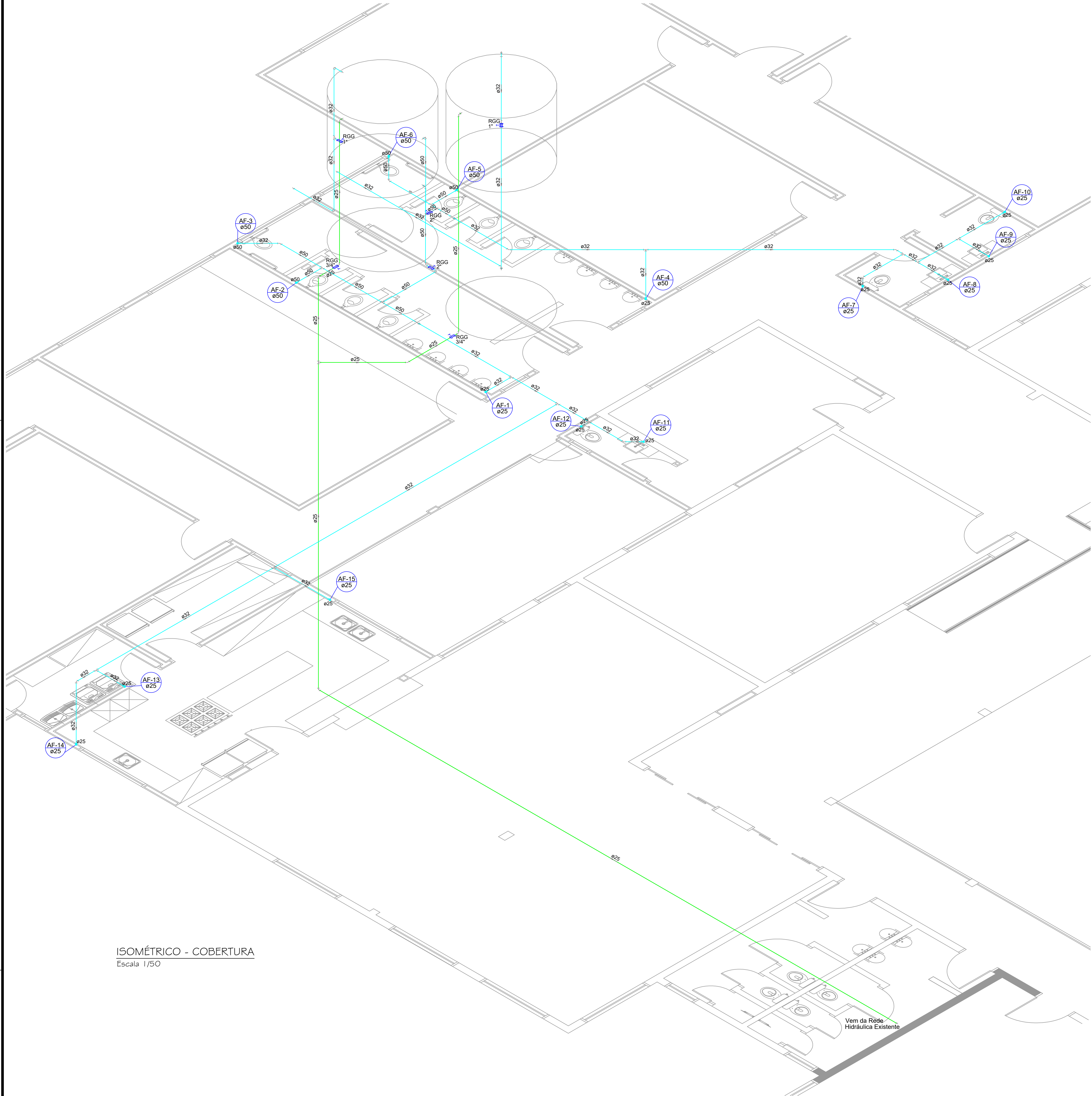
RESERVATÓRIO Capacidade 5.000 litros
